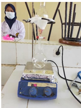
Proses refluks selama 5 jam pada suhu 75^\circ\text{C}
