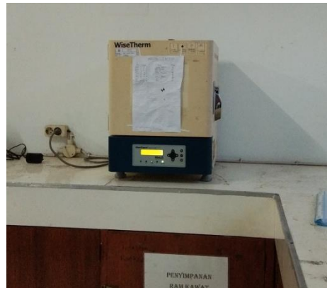
Proses pembuatan arang dengan tanur pada suhu 400°C
