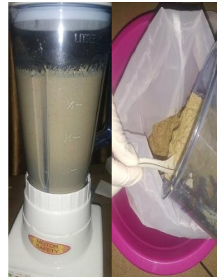
Ampas di blender dan disaring dengan kain saring 200 \mu m mesh
