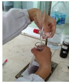
Larutan di tambah metilen blue dan di titrasi dengan dextrose
