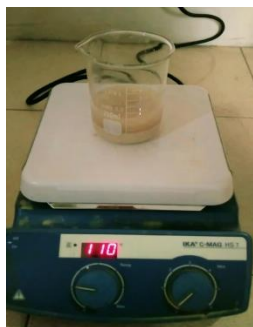
Sampel di uapkan pada suhu 110°C untuk menguapkan HCl
