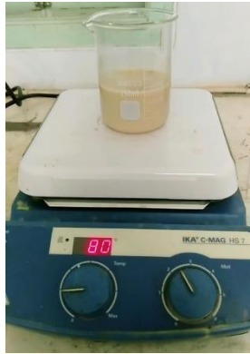
Pembuatan suspensi pati 30% dengan 30 gram pati biji limus dilarutkan dalam 100ml HCl 1,35%, kemudian di hidrolisis pada suhu 80°C selama 30 menit.
