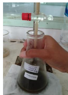
Sampel di tambah metilen blue dan di titrasi dengan larutan maltodekstrin
