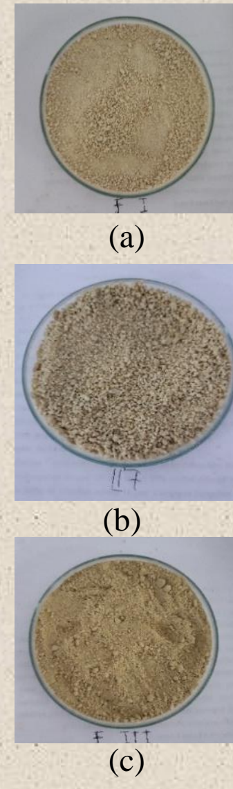
Gambar 3. Granul hasil formulasi (a) konsentrasi ekstrak 2%, (b) konsentrasi ekstrak 4%, (c) konsentrasi ekstrak 8%
